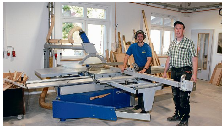
Modern ausgestattet: Sobald an einer Maschine gearbeitet wird, schaltet sich die vollautomatische Absauganlage ein.
